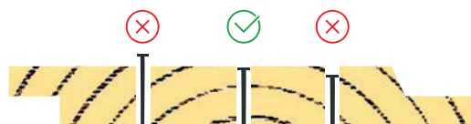
Fig. 1.10. Korrekt dybde på innfestningsmiddel.
